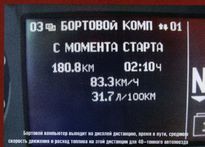
Бортовой компьютер выводит на дисплей дистанцию, время в пути, среднюю скорость движения и расход топлива на этой дистанции для 40-тонного автопоезда
