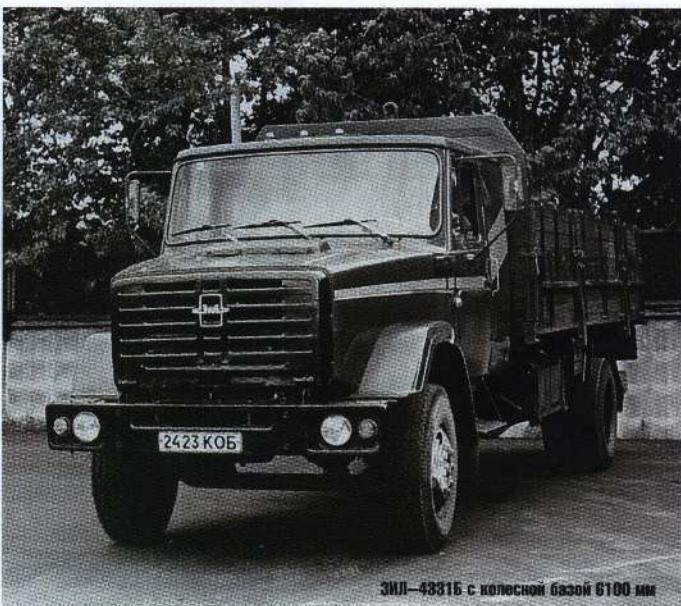
ЗИЛ-4331Б с колесной базой 6100 мм
