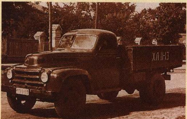
В 1948 г. «УАЗ» разработал собственную модель грузовика – «УАЗ-300» – в основном повторявшую компоновку полупортерки, но имевшую 50-сильный двигатель от «Победы». Фото с разрешения В.А. Несоленого
