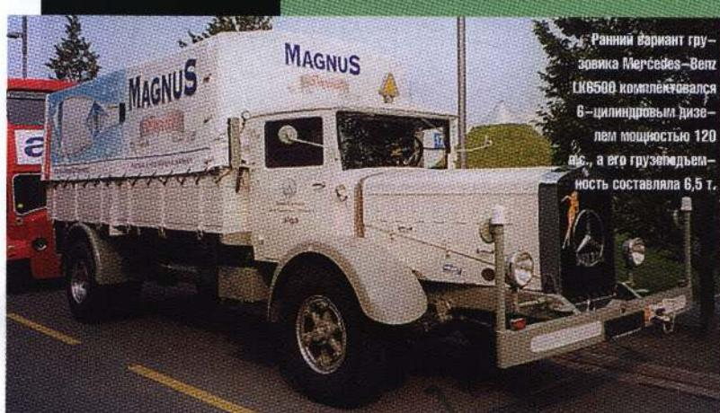
Ранний вариант грузовика Mercedes-Benz LK 6500 комплектовался 6-цилиндровым дизелем мощностью 120 л.с., а его грузоподъемность составляла 6,5 т.
