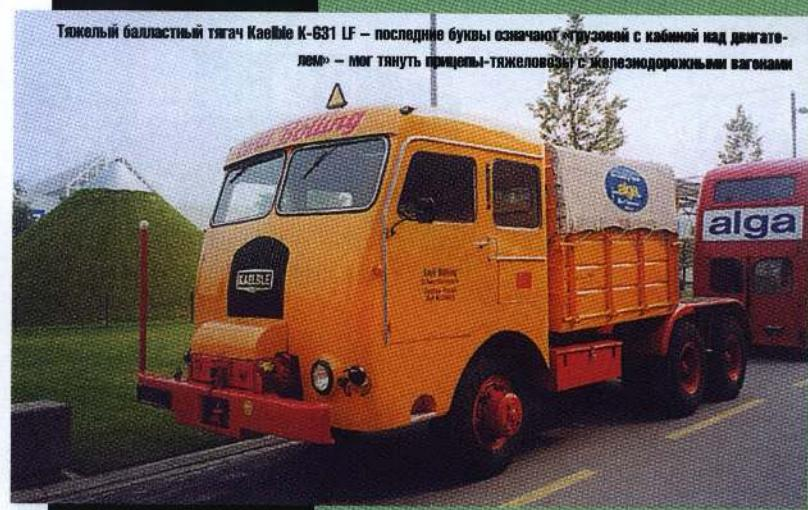
Тяжелый балластный тягач Kaelble K-631 LF – последние буквы означают «грузовой с кабиной над двигателем» – мог тянуть прицепы-тяжеловесы с железнодорожными вагонами
