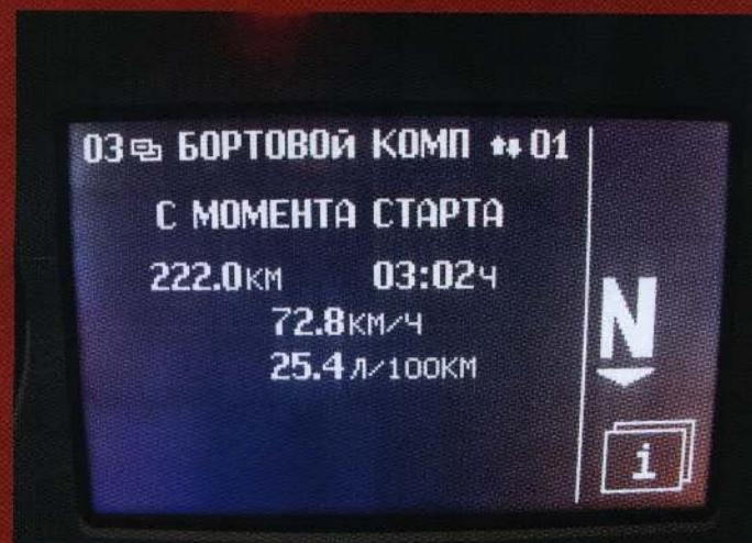
Средний расход топлива пустого автомобиля
