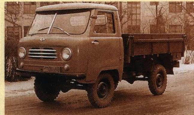
Первый опытный образец грузовика «УАЗ-450» 1957 года имел более сдержаный дизайн кабины и двери, открывающиеся против хода машины. Фото из архива А.С. Исаева
