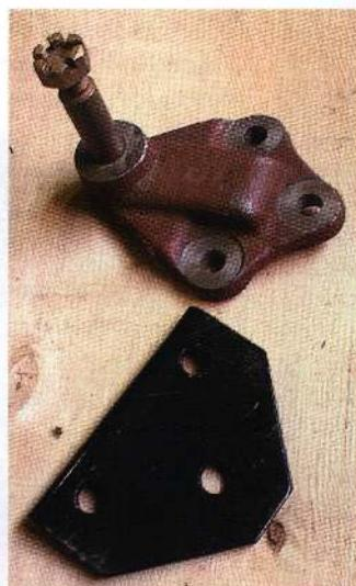
Для верхних кронштейнов задних амортизаторов теперь предлагаются усиливющие пластины. При установке кронштейна эта пластина ставится с внутренней стороны лонжерона рамы и по идеи она должна снизить нагрузки в точках крепления кронштейна, чтобы предотвратить растрескивание рамы в этих местах
