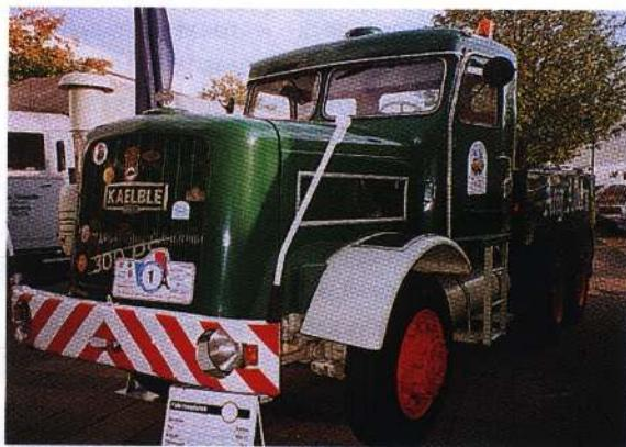
Сегодня компания Kaelble производит карьерные самосвалы и внедорожные тягачи для тяжелой промышленности и строительства. А в начале 60-х годов она снабжала перевозчиков тяжелыми балластными тягачами, наподобие этого KDF 22, способного буксировать прицепы-тяжеловесы общим весом 100 т.
